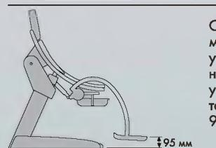
Опоры для ног можно опускать под углом 0° на 200 мм над полом под углом - 3° наклон тазовой секции, 95 мм над полом
